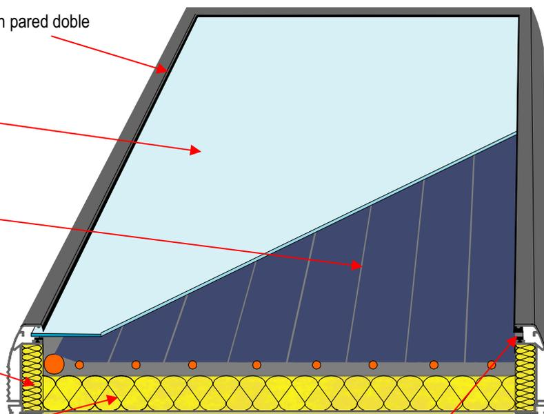
Pared posterior de chapa de aluminio resistente al agua del mar
